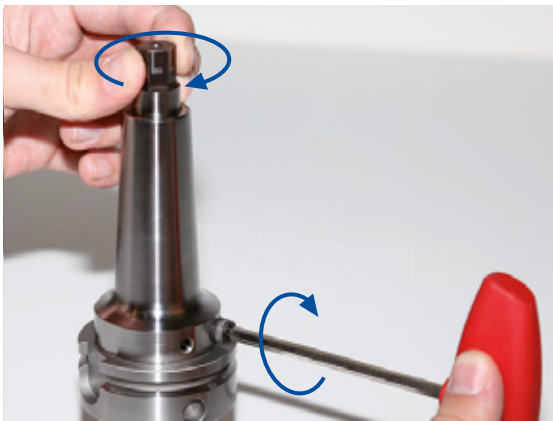
Abbildung 1: Spannschraube und Werkzeugprüfling drehen
