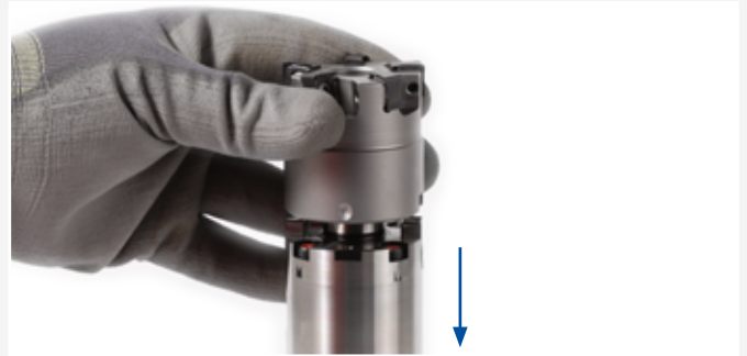
2. Den Fräseraufsteckdorn in eine Wechsellvorrichtung einspannen.
