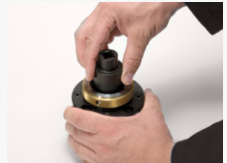
3. Im Uhrzeigersinn drehen, bis die Nase der Spannpatrone am Spannstift einrastet.
