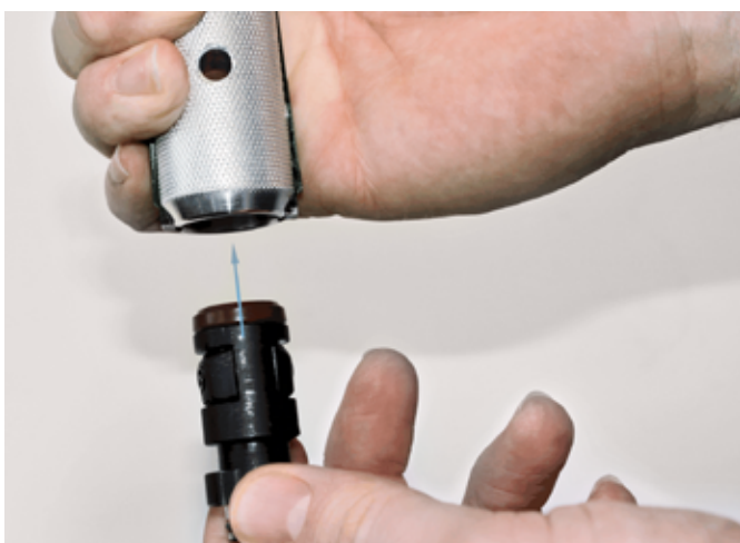
Einsetzen der KS-Spannpatrone in die KS-Montagezange
