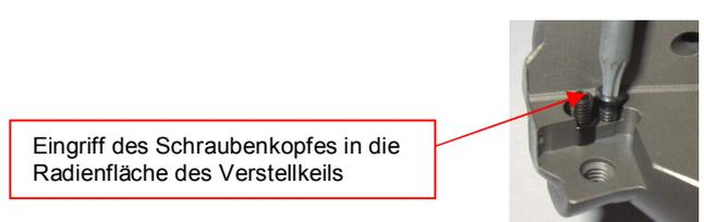
Bild 4: Einschrauben der Arretierschraube
