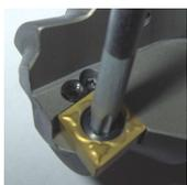
Bild 10: Anziehen der Schraube M4,5
