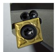
Bild 11: eingestellte Wendeschneidplatte
