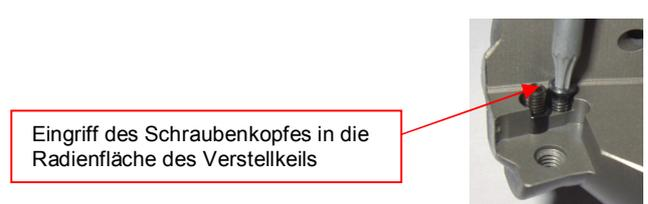
Bild 4: Einschrauben der Arretierschraube
