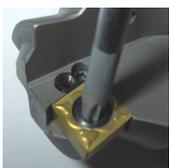
Bild 10: Anziehen der Schraube M3,5
